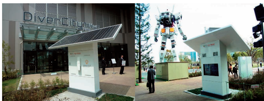
資料5.6.2 ダイバーシティのソーラー蓄電サイネージ
