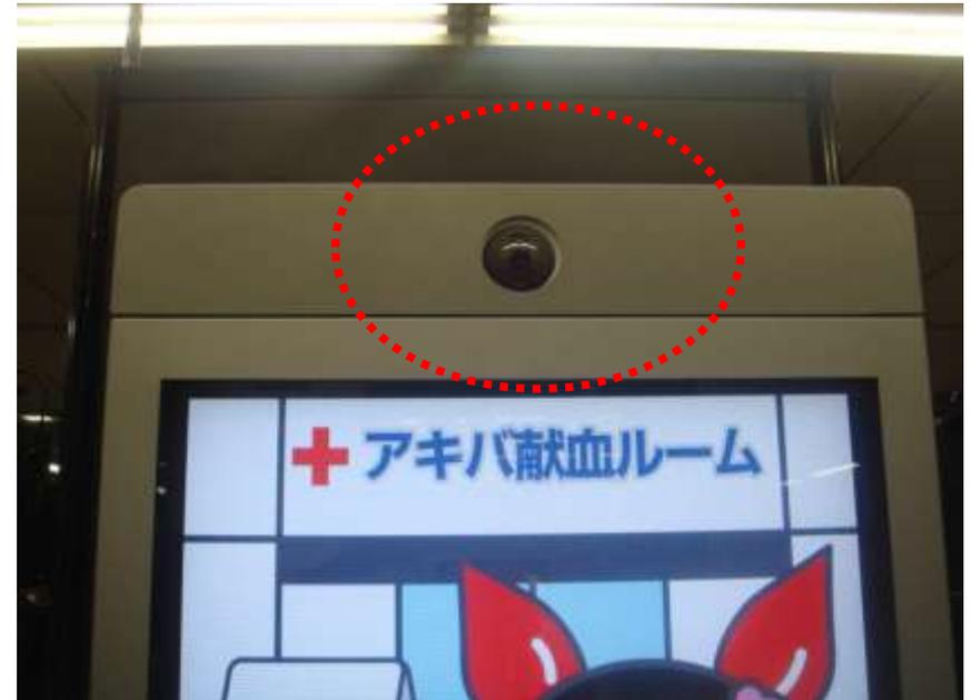
効果測定はNEC製「視認効果測定ソリューション」とマクニカネットワークス社の視聴者測定システム「AlliO」、OKIの広告効果測定ミドルウェア「Signage Eye™」を活用。カメラで撮影した映像は、処理結果のデータのみを出力し、画像を残さないことにより、プライバシー保護に配慮した。
